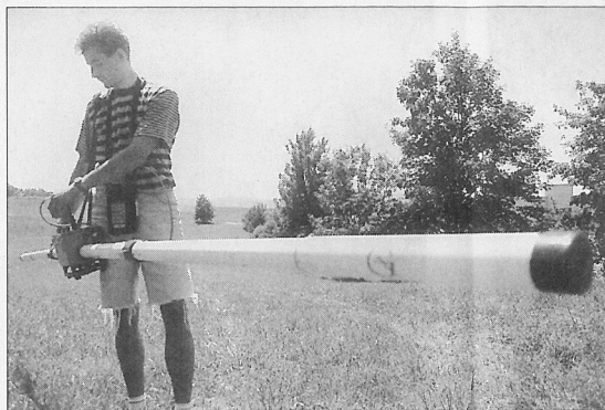
Bis in sechs Meter Tiefe: Gerät zur elektromagnetischen Leitfähigkeitskartierung
